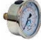
Manómetro con glicerina ALTAMIRA. Cuerpo en acero inoxidable. Carátula: 2.5". 1/4" NPT conexión trasera. Escalas en lb/plg<sup>2</sup> (psi) y kg/cm<sup>2</sup>
