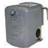
Interruptor de presión Square D. **Desconexión baja presión** (FSG2M) 1/4" NPT. Tipo de rosca: Hembra. Rango de presión: 34-65 psi
